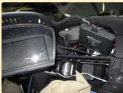
La centralina per il controllo delle funzioni video è stata alloggiata dietro il monitor di bordo; in evidenza il cavo in ingresso dall'impianto di bordo con il Can-Bus e quello in uscita che ritorna al monitor.
