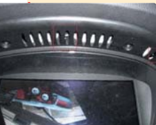
All'interno dei riquadri rossi in evidenza i sensori IR dei telecomandi, del VM 070 e della centralina.
