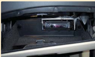
A lavoro ultimato, in fondo al cassetto la parte frontale del VM 070: massimo occultamento ed una discreta praticità di utilizzo.
