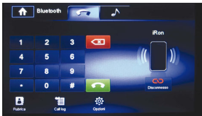
Il Bluetooth permette di effettuare chiamate dirette, sincronizza la rubrica o ricompone le ultime chiamate. Nonostante il telefono sia collegato via BT, l'icona a destra indica che non c'è connessione di alimentazione.
