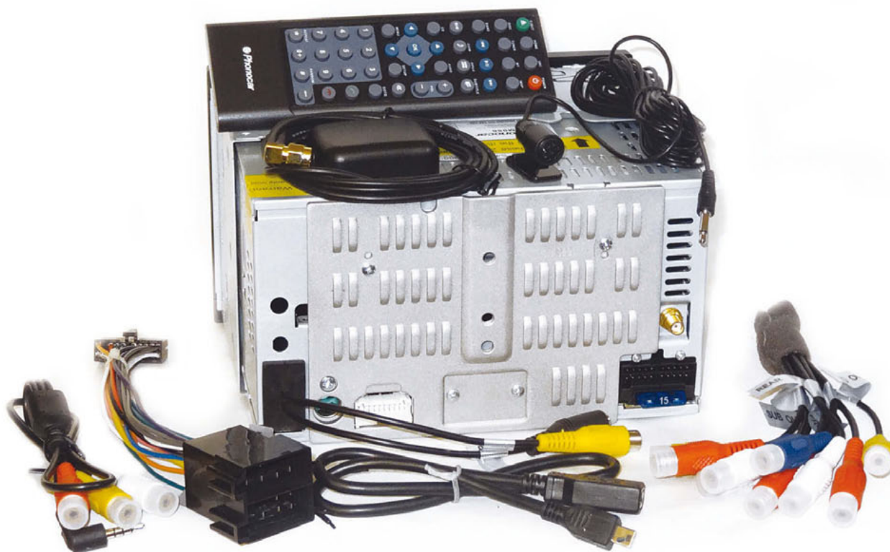
Due connettori multipolari per i corti cavetti terminati con connettori ISO per altoparlanti e alimentazione e con connettori RCA per ingressi ed uscite audio-video, due prese per le antenne FM e GSM e la connessione del jack per il microfono Bluetooth. Ed il gioco è fatto.
