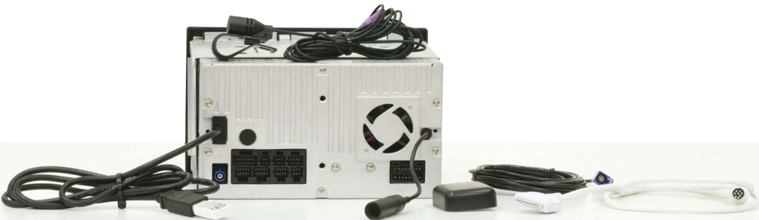
Un'ampia piastra in pressofusione costituisce il fondello del VM 007 e svolge funzione di dissipatore termico, coadiuvata da una piccola ventolina. Due cavi fuoriescono dal fondello: il corto cavetto per la connessione d'antenna FM ed il lungo cavo USB su cui è inserito il Dongle per il wi-fi (in dotazione). Tutte le altre connessioni, ad eccezione dell'antenna GPS che gode di un proprio connettore indipendente, sono realizzate attraverso l'ampio parco di connessioni multipolari, ognuna di forma diversa, dedicata a tutti gli interfacciamenti. Un secondo connettore, a destra, offre i dispositivi di alimentazione e l'uscita altoparlanti su un corto adattatore per terminazioni ISO.
