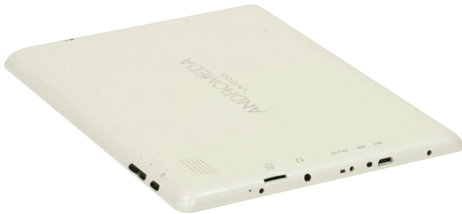
La maggior parte delle connessioni del tablet Phonocar VM 508, detto anche "Andromeda", sono disposte sul lato inferiore.
